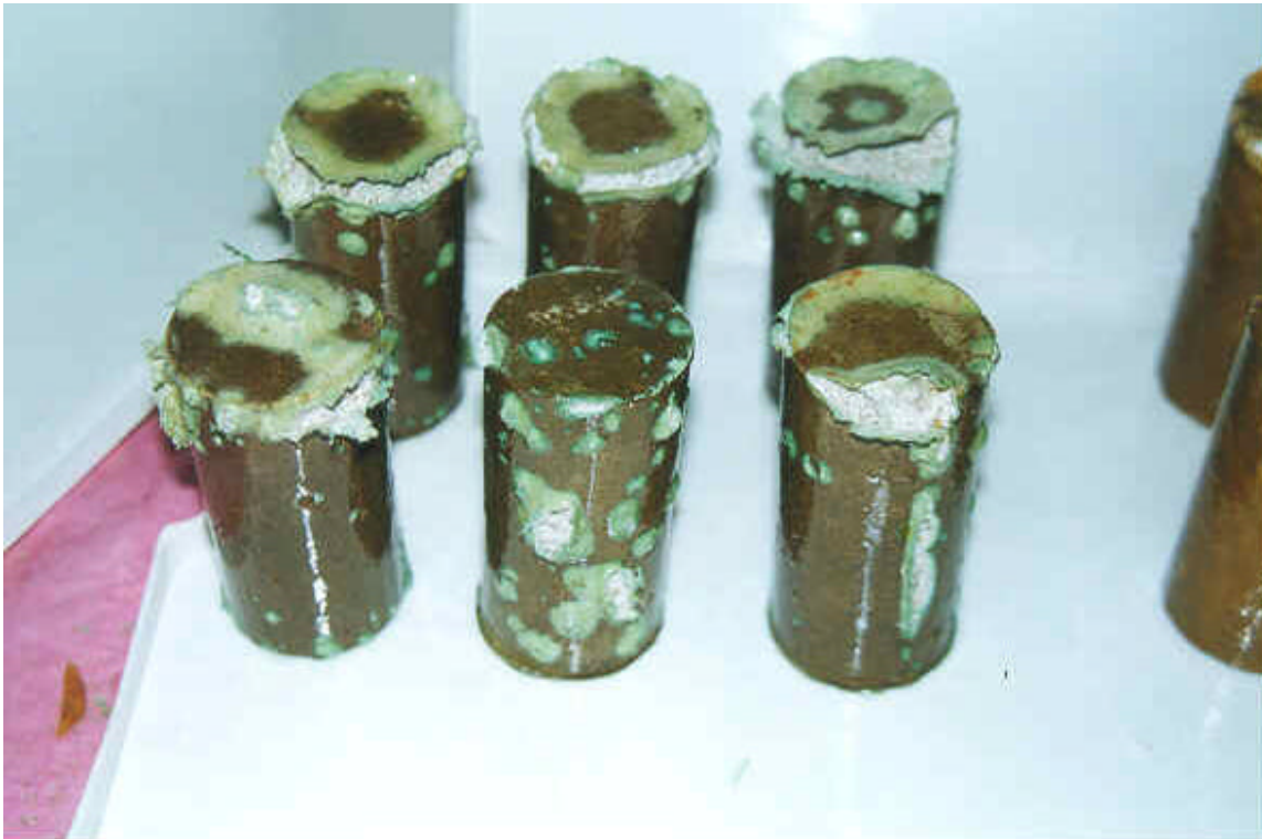
Foto 3: Corpos de prova revestidos com epóxi B, após 21 dias de imersão em solução de ácido de sulfúrico altamente agressiva (20%).
