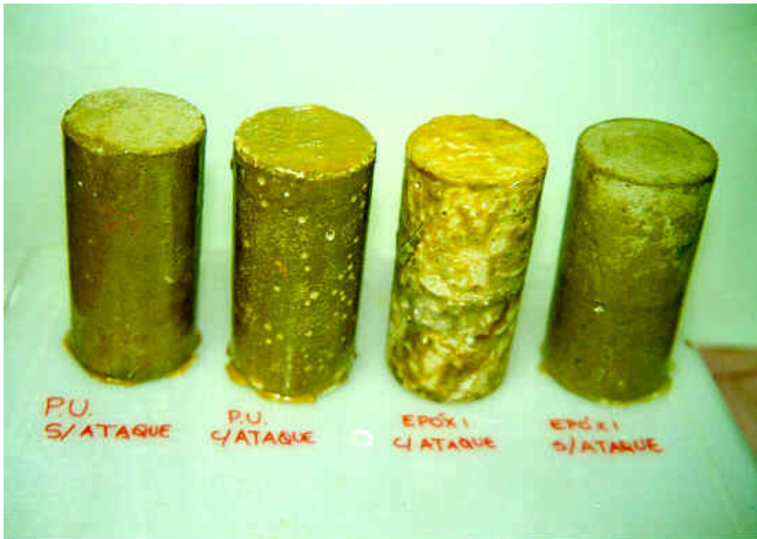
Foto 1: Avaliação visual de corpos de provas imersos em solução com baixa concentração de ácido sulfúrico.
