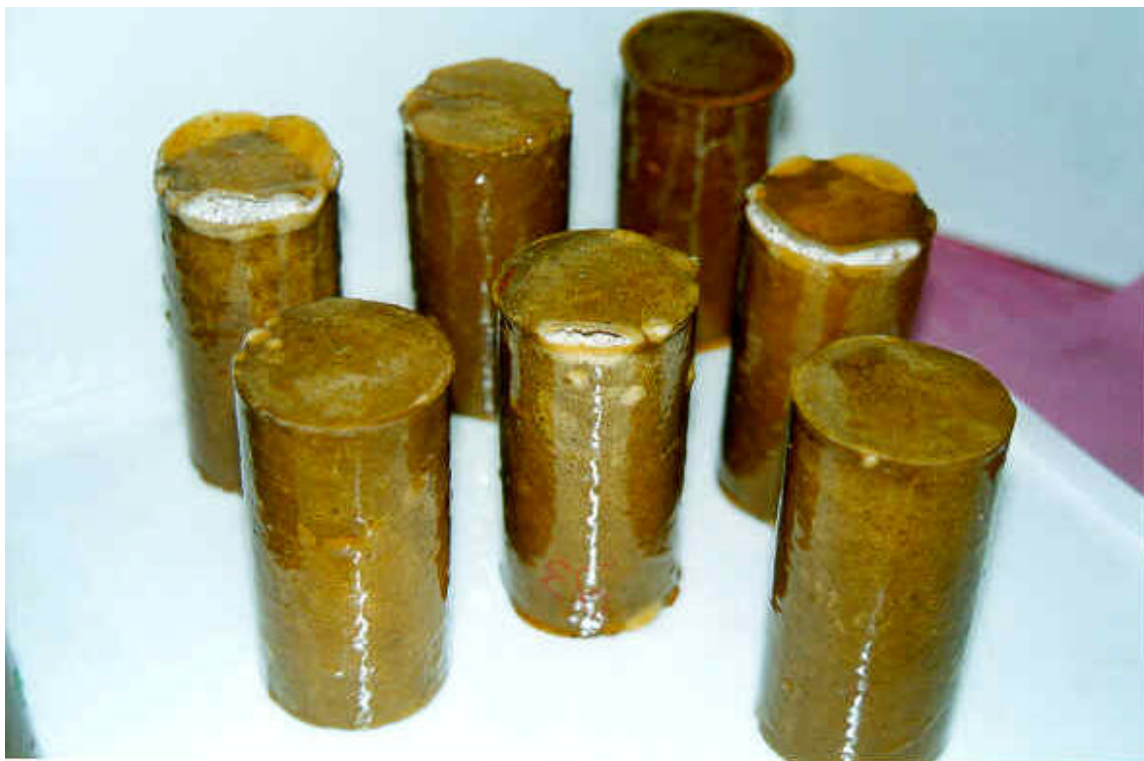
Foto 2: Corpos de prova revestidos com poliuretana de origem vegetal, após 21 dias de imersão em solução altamente agressiva de ácido sulfúrico (20%).
